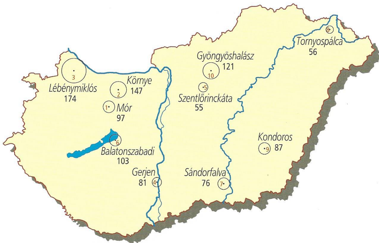
2. ábra. A mérőhálózat pontjai az évi átlagenergia-mennyiség feltüntetésével (W/m 2 )
